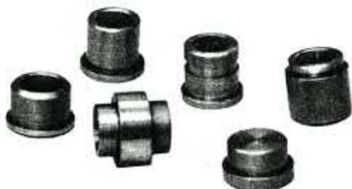
Diese verschiedenartigen Teile können in einer Gruppe bearbeitet werden.
