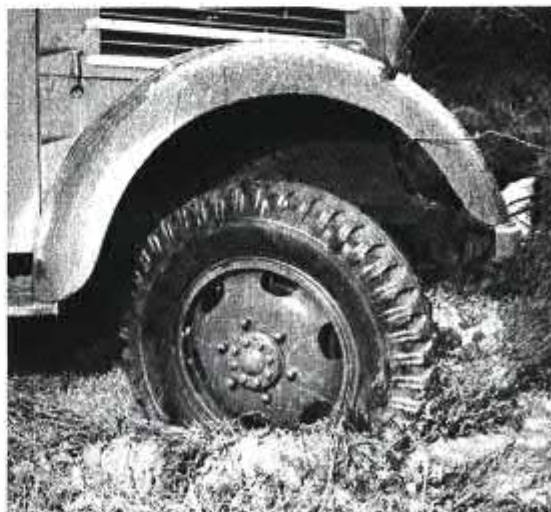
Der Robur-Pritschenwagen Typ Garant 30K mit Allradantrieb durchfährt eines der Wasserlöcher, die in der Versuchsstrecke in großer Zahl vorhanden sind.
