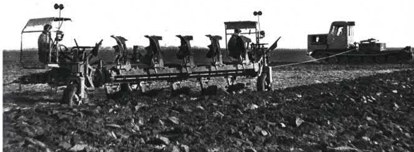
Dieselaggregat SZ 24 mit Seilzugpflug B 090 während der Arbeit in der Magdeburger Börde. - Auf der Leipziger Frühjahrsmesse wurden zwei dieser Aggregate mit dem dazugehörigen Pflug erstmalig ausgestellt. Viele Fachleute aus dem In- und Ausland zeigten für diese Maschinen reges Interesse
