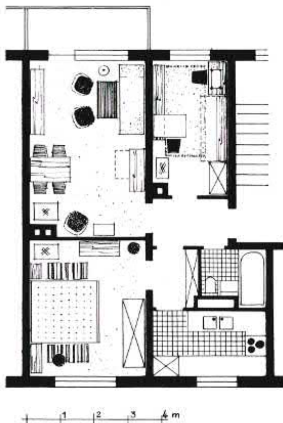
Grundriß einer 2 1/2-Zimmer-Typenwohnung in Großblockbauweise
