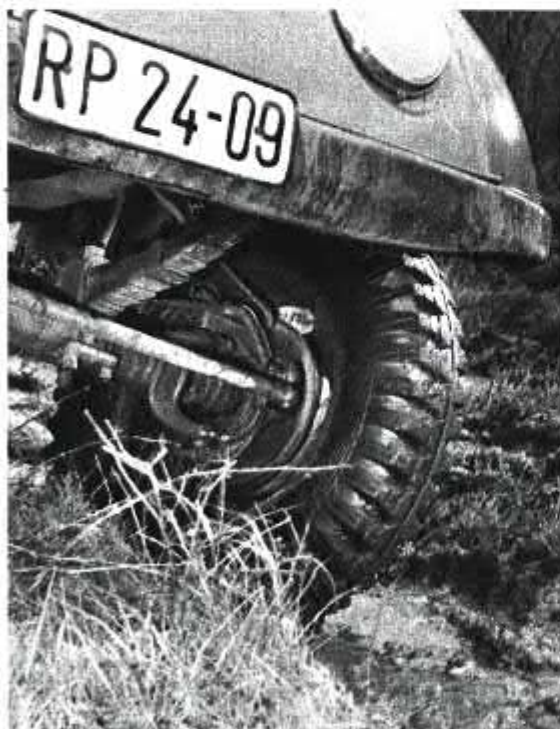
Der Robur-Pritschenwagen Typ Garant 30K mit Allradantrieb durchfährt eines der Wasserlöcher, die in der Versuchsstrecke in großer Zahl vorhanden sind.
