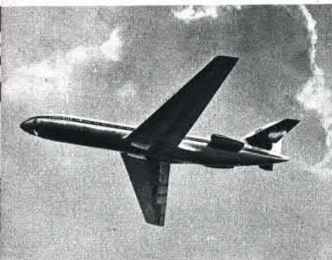
Die „Caravelle“ der SAS. Interessant ist die Anordnung der Triebwerke am Ende des Rumpfes
